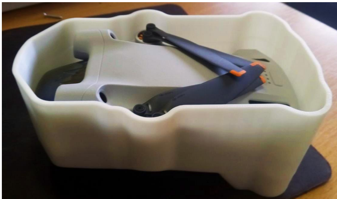
Рис. 6. Футляр для квадрокоптера DJI Mini 3 Pro, распечатанный на 3D принтере Flyingbear P905 с использованием вышеуказанных рекомендаций.
